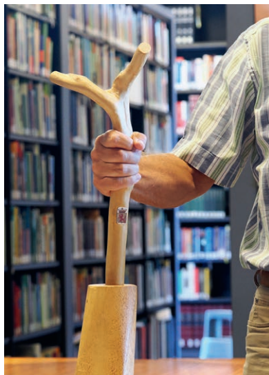
De kolderstok, zoals gebruikt aan boord van zeventiende-eeuwse schepen. Afbeelding uit 'Het VOC-retourschip. Een panorama van de 17de- en 18de-eeuwse Nederlandse scheepsbouw' door H.N. Kamer (Amsterdam, 1995)
